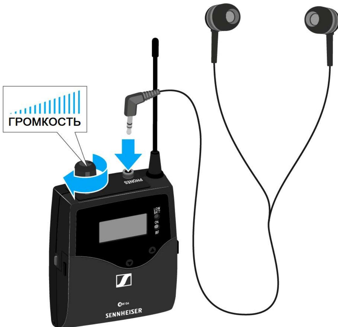
**i** Экран кабеля наушников служит антенной для второго плеча разнесённого приёма. Подробнее о назначении контактов см. “Назначение контактов”.
